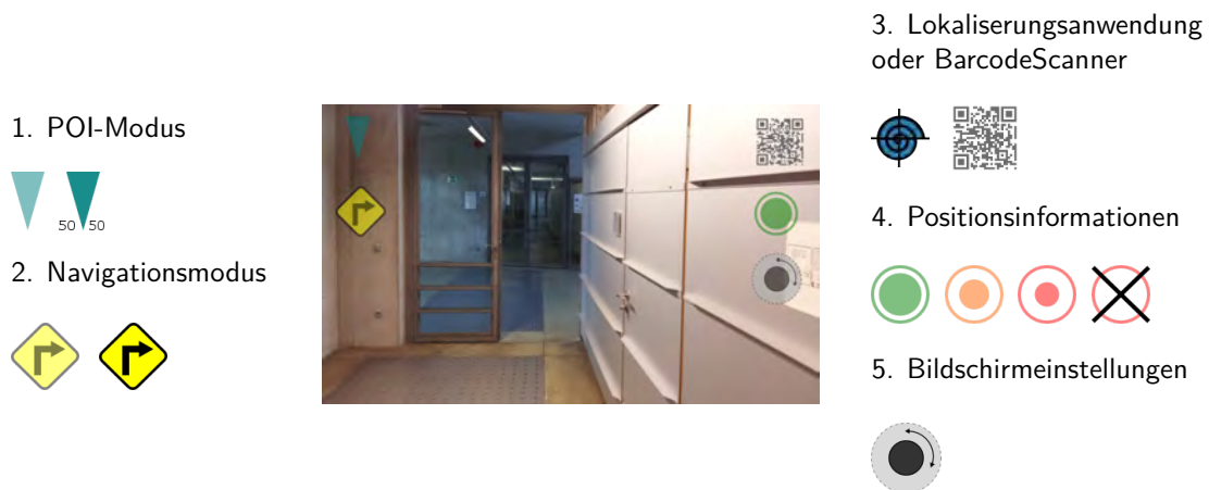
Abbildung 4.6: AR-Ansicht des Augmented-Reality-Browsers mit Bedienelementen
