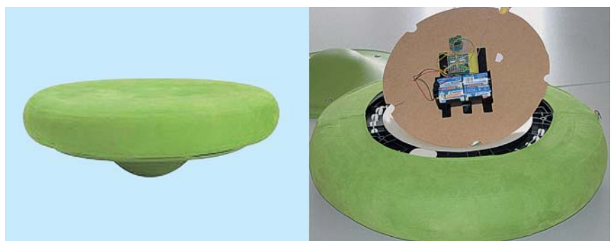
Bild 3: Auf Prototyp 1 wird eine Bewegung (hier eine einfache Linie) gezeichnet, die Eingabe bestätigt und dann abgefahren
