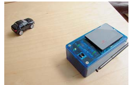
Bild 2: Prototyp 2 erhält die Bewegungseingabe über ein kapazitives Touchpad und interagiert dann mit der Fernsteuerelektronik
