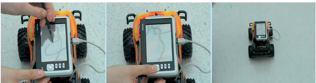
Bild 3: Auf Prototyp 1 wird eine Bewegung (hier eine einfache Linie) gezeichnet, die Eingabe bestätigt und dann abgefahren
